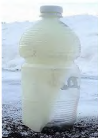
Рисунок 2 –Застывшее и потерявшее текучесть дизельное топливо летней марки [2]
